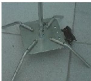
Os radiais foram feitos também com tarugos de alumínio de **3/8"**. **O comprimento é de 20 cm.** Estes tarugos são dobrados numa posição de **45º** graus e fixados por parafusos com arruelas de pressão. Coloque os tubos de alumínio (4 radiais) sobre o tarugo da mesma forma como o elemento irradiante. É importante lembrar que o comprimento dos radiais (146cm), começa a contar do centro da placa base. O mesmo vale para o elemento ativo.
